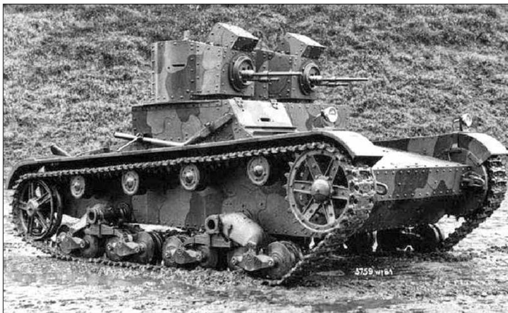
Британский легкий танк «Виккерс, 6-тонный» Mk. E Type A (двухбашенная компоновка) (источник: <http://tanki-v-boju.ru/tank-vickers-mk-e-vickers-mk-e/>)
