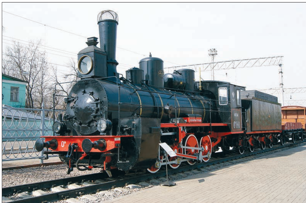
Паровоз серии С н («нормальный тип 1901 г.»)
