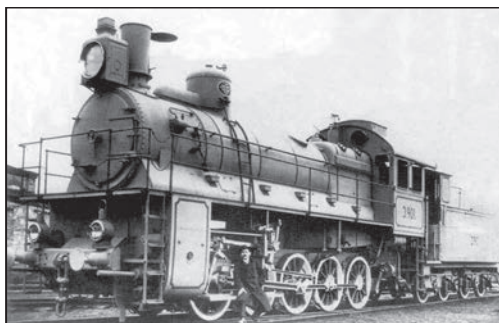
Первый паровоз серии Э, изготовленный Луганским заводом в 1912 г.
